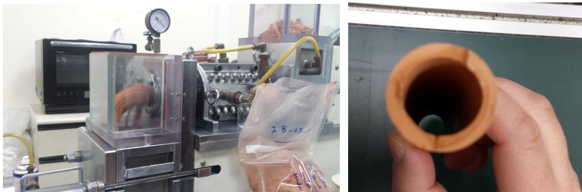
46-р зураг. KTE-50S маркийн экструдерээр хэвлэсэн мембран
