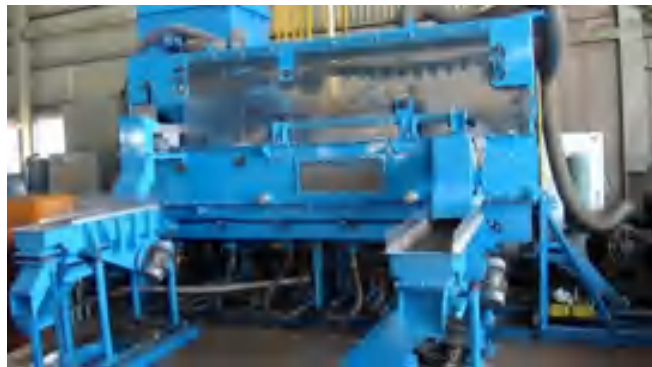
Зураг 3.7.1 Буцламтгай давхарга бүхий хуурай сепаратортай туршилтын үйлдвэр (Хүчин чадал: 1.0 тонн/цаг)
