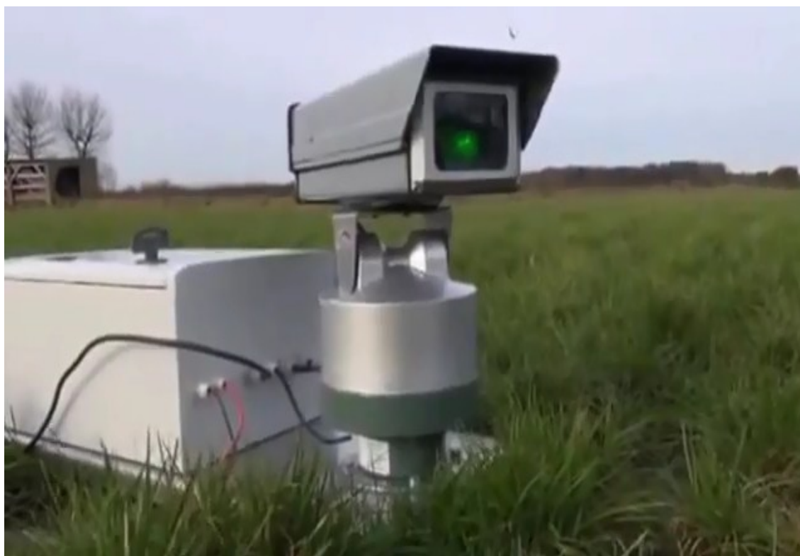
1-р зураг. Лазерын тусгалыг ашигласан шувуу үргээх төхөөрөмж
