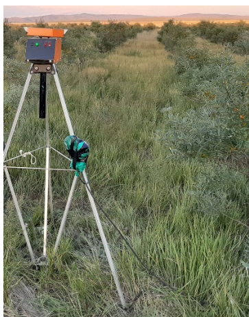
15-р зураг. Шувуу үргээх төхөөрөмжийн байрлуулсан байдал. (2020.07.22)
