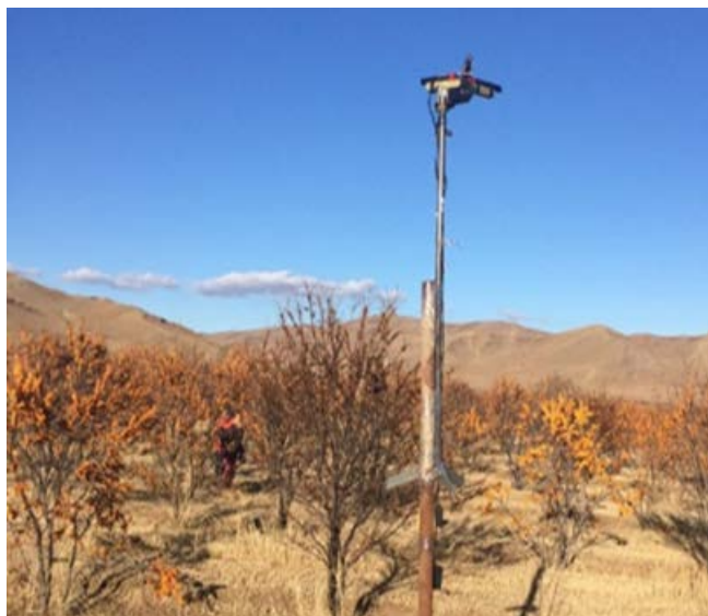
5-р зураг. 220 В – ын хүчдлээр ажилладаг шувуу үргээх төхөөрөмжийг талбайд туршиж байгаа байдал
