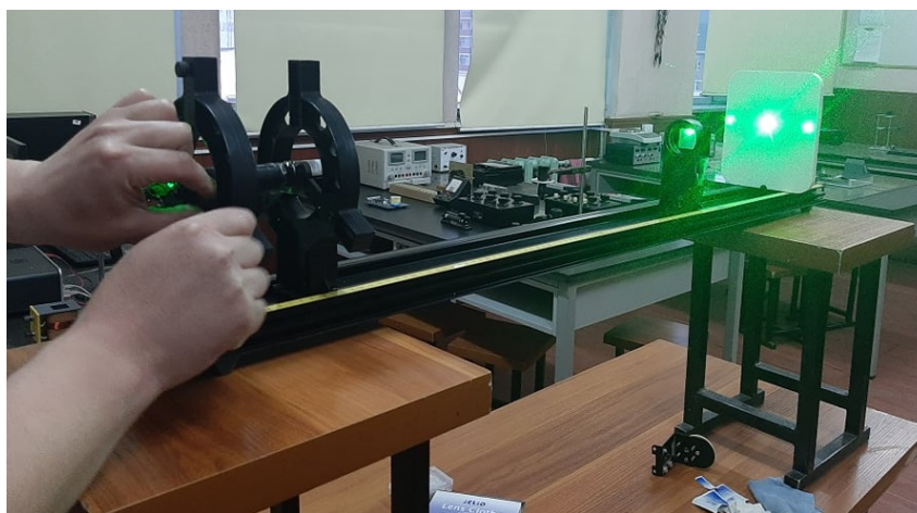
9-р зураг. Лазерын гэрлийн долгионы уртыг тодорхойлж буй байдал.
