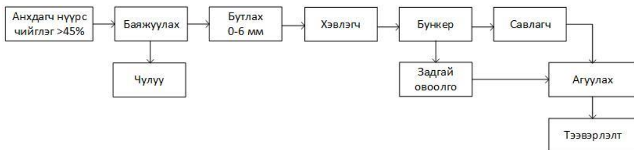
Зураг 12. Холбогчгүй шахмал түлш үйлдвэрлэх технологийн схем (Испани, Verdes)
