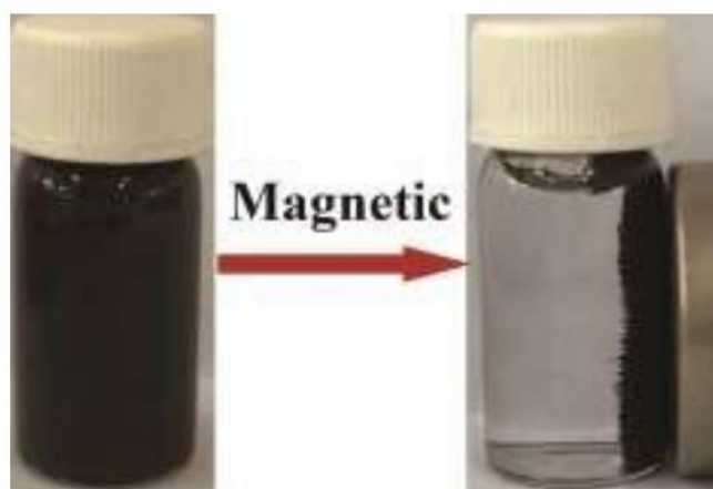
Зураг 50. Fe_3O_4 болон PEG холимгийг усан уусмалаас соронз ашиглан салгах процесс
