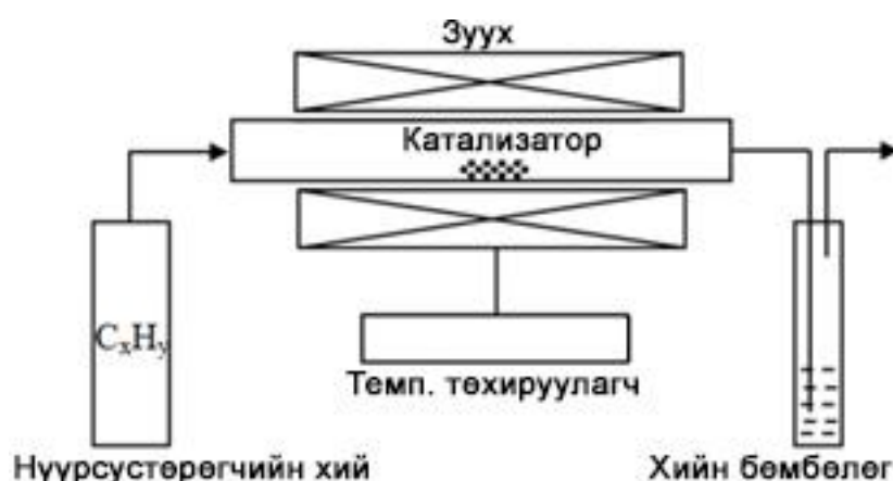
Зураг 11. ННХ ургуулж буй химийн ууршуулалтын реакторын ерөнхий бүдүүвч
