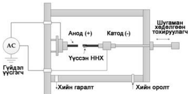
Зураг 4. Нуман цахилалтын аргаар ННХ гарган авах ерөнхий схем (орчин нь инертийн хий болон катализатор (төмөр, никель эсвэл кобальт))
