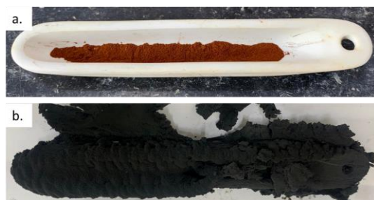
Зураг 22. Гарган авсан \text{Fe-SiO}_2 катализатор (a) болон ННХ-н (b) гадаад байдал
