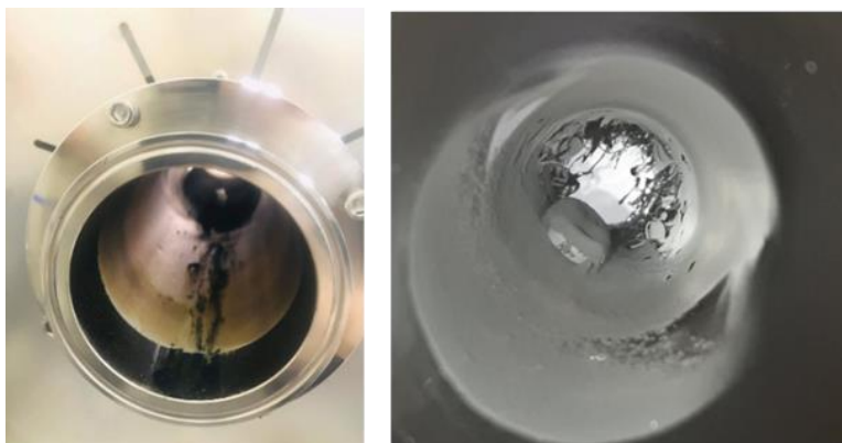
Зураг 12. Реакторын дотор нүүрстөрөгчийн nano хоолой ургасан байдал
