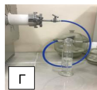
Зураг 11. А. Нүүрстөрөгчийн nano хоолойг химийн ууршуулалтын аргаар гаргах авах реактор буюу зуух, Б. Аргон хийн болон Ацетилен хийн холболт, В. Хийн урсгалын хурд хэмжигч болон дотоод даралт хэмжигч, Г. Ялгарах хийг шүүх усан шүүлтүүр
