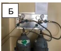
Зураг 11. А. Нүүрстөрөгчийн nano хоолойг химийн ууршуулалтын аргаар гаргах авах реактор буюу зуух, Б. Аргон хийн болон Ацетилен хийн холболт, В. Хийн урсгалын хурд хэмжигч болон дотоод даралт хэмжигч, Г. Ялгарах хийг шүүх усан шүүлтүүр
