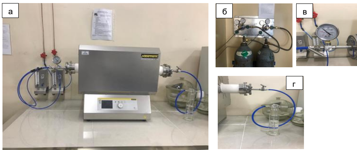
Зураг 18. CVD аргаар ННХ гаргах авах туршилтын реактор буюу зуух (ерөнхий гадаад байдал (а), аргон хийн болон ацетилен хийн холболт (б), хийн урсгалын хурд хэмжигч болон дотоод даралт хэмжигч (в), ялгарах хийг шүүх усан шүүлтүүр (г))
