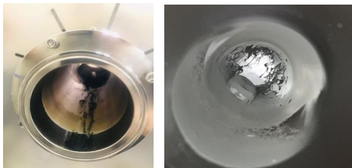
Зураг 21. Реакторын дотор ННХ ургасан байдал
