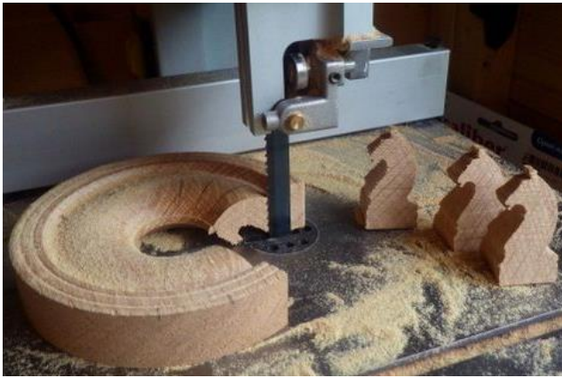
Технологи №7. Токарын машин дээр зорсон амьтаныг туузан хөрөөгөөр хэсэглэн хуваах
