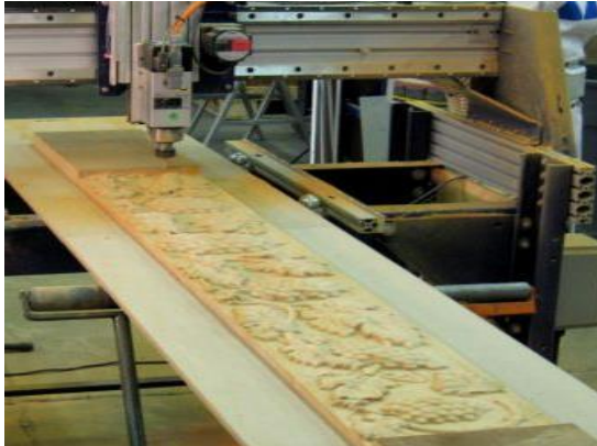
Технологи №1. CNC машинаар сийлбэрлэх, олноор хялбар зүсэх арга
