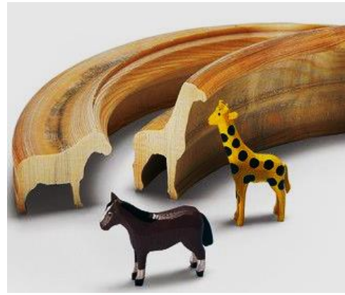
Технологи №7. Токарын машин дээр зорсон амьтаныг туузан хөрөөгөөр хэсэглэн хуваах
