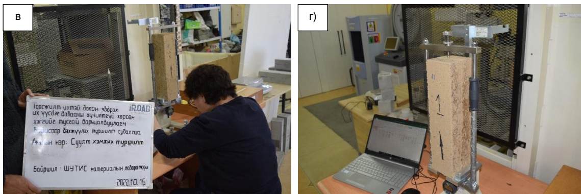
Зураг 1.2. Суултыг хэмжих үеийн туршилт, шинжилгээний ажлын зургууд; а) Бэлтгэсэн 6 сорьц; б) Суулт хэмжих багаж в) Суулт хэмжих туршилтын үйл явц г) Үр дүн боловсруулах хэсэг
