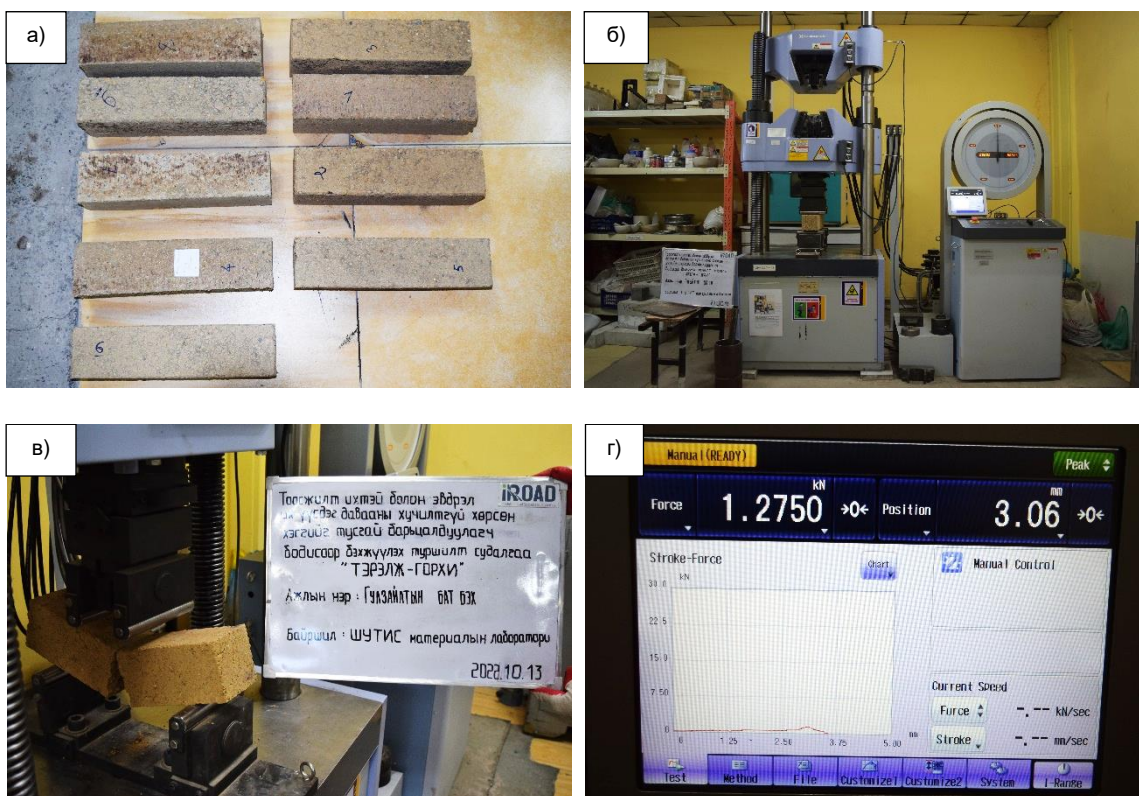
Зураг 1.1. Гулзайлтын бат бэхийн туршилт шинжилгээний ажлын зургууд; а) 3 дээжээр нийт 9 туршилт; б) Universal Testing Machine UH-F500 в) Гулзайлтамд орсон дээж г) Дээжид багажаас ирж байгаа хүч болон гулзайлтын хэмжээ
