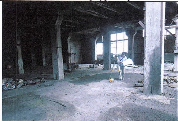
13-р зураг. Баганын хазайлтыг шалгаж байна.
