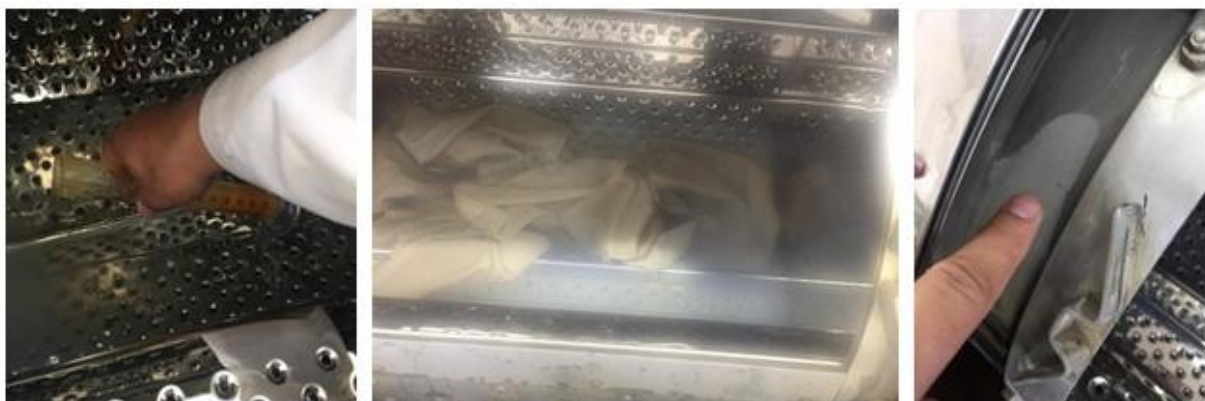
Зураг 13. Боловсруулалтын явц, машины барабаны гадаргуу дээр үлдсэн бодис
