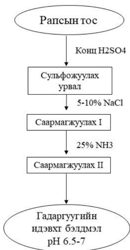
Зураг 6. Рапсын тосыг сульфожуулах технологийн схем
