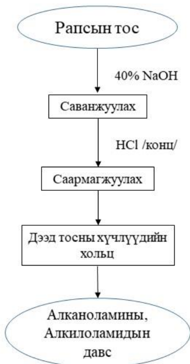
Зураг 7. Алканоламин ба алкилоламидын давс гарган авах технологийн схем
