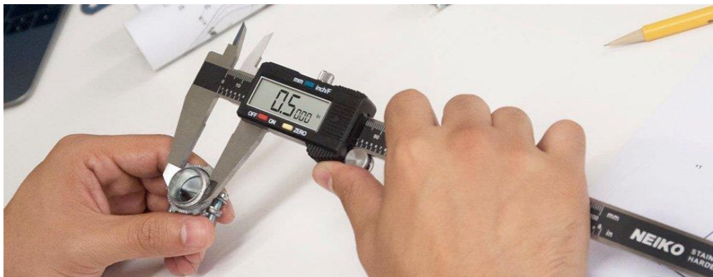
Зураг 6. Навчны зузаан хэмжигч калифер багаж (Electronic Digital Caliper)
