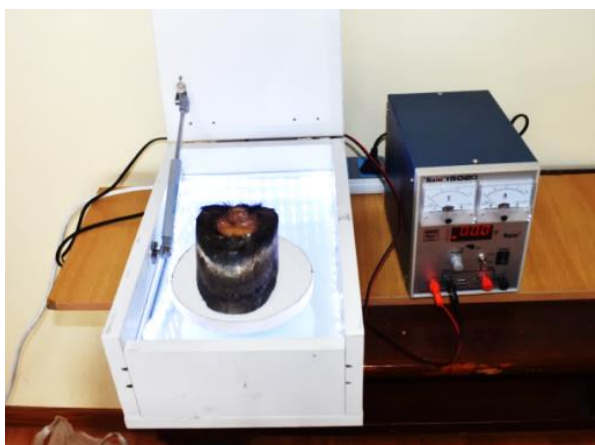
Зураг 49. Адууны туурайг тасалгааны буюу лабораторын нөхцөлд гэрэл зургийн аргаар бэхжүүлэх төхөөрөмжийн үлгэрчилсэн загвар
