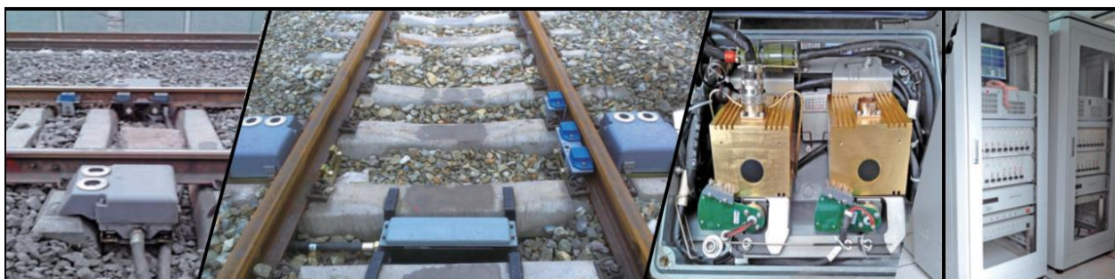
Зураг В.23. THDS Хэт улаан туяагаар тэнхлэгийн температурыг илрүүлэх систем
