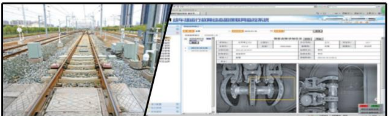
Зураг В.27. Цахилгаан хөдлөх бүрэлдэхүүний гэмтлийн зургийг илрүүлэх систем (TEDS)
