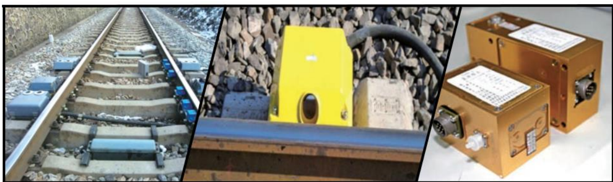
Зураг В.24. THDS Хэт улаан туяаны дугуйны температур хэмжигч систем
