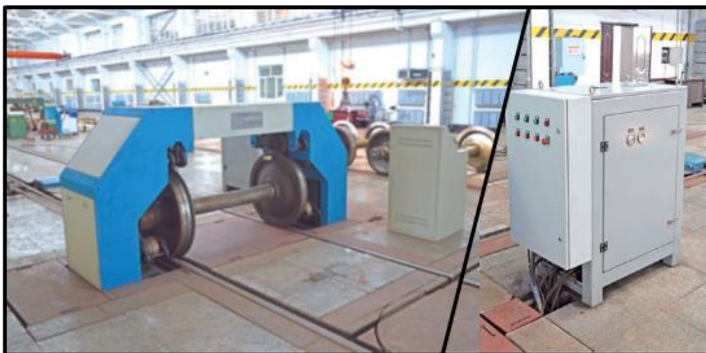
Зураг В.32. Ачааны галт тэрэгний холхивчийг салгахгүйгээр оношлох төхөөрөмж
