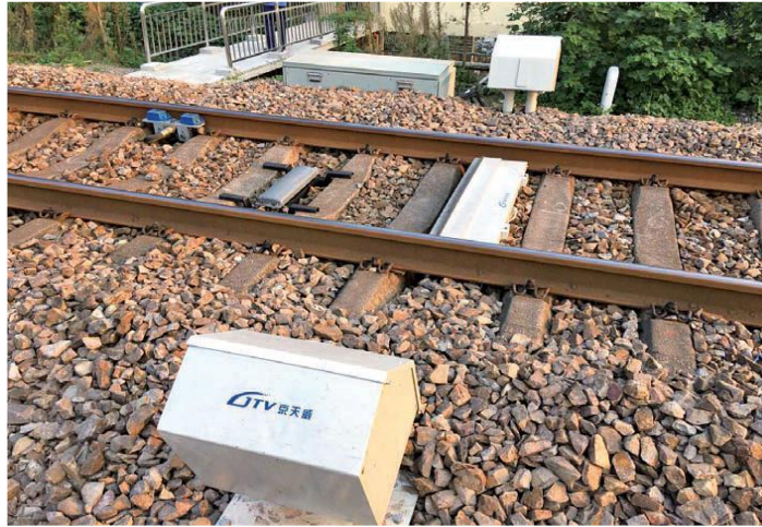
Зураг В.29. Зорчигчийн вагоны гэмтлийг замын хажууд байрлах зургийн аргаар хянах систем (TVDS)
