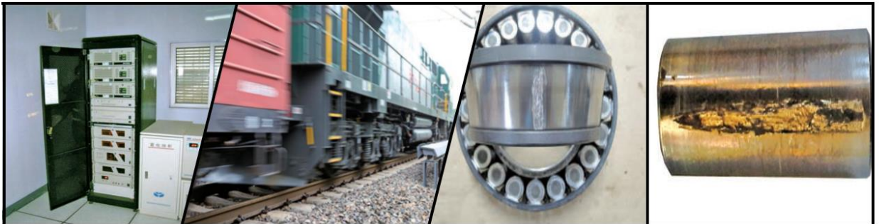
Зураг В.26. Хөдлөх бүрэлдэхүүний эргэгч холхивчны гэмтлийг акустик аргаар оношлох систем
