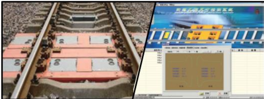
Зураг В.30. Дугуйны хөдөлгөөнт үеийн геометрийн хэмжүүрийн систем
