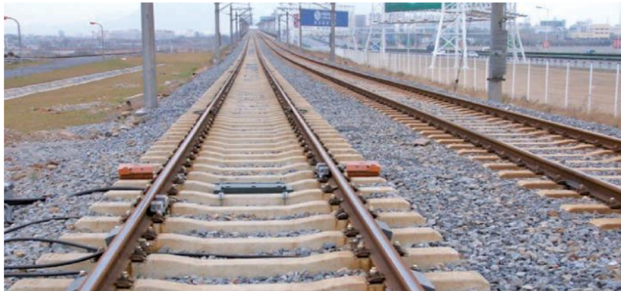
Зураг В.31. Хотын төмөр замын хөдлөх бүрэлдэхүүний дугуйн өнхрөх гадаргууны гэмтэл, тэнхлэгийн температурыг хянах систем
