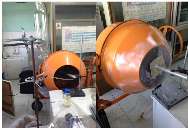
Зураг 3. Эмийн бэлдмэлийн холигчид бэлтгэх байдал. Эхний зураг: Эмийн бэлдмэлийн дүүргэгч бодисыг холигч аппаратад хийж 3 цагийн турш эргүүлэн нэгэн жигд болтол хутгана. Хоёрдахь зураг: Эмийн бэлдмэлийн дүүргэгч дээр 3 хувилбараар бэлтгэсэн ивермектины уусмалыг дуслаар нэмж, холигчоор нэгэн жигд болтол тараан хольж эмийн бэлдмэлийн хувилбаруудын нунтаг хэлбэрийг бэлтгэв.
