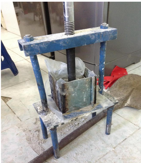
Зураг 5. Эмийн бэлдмэлийг орц нунтгийг долооцын шахмал блок болгон шахах багаж.
