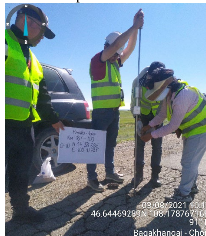
УБ-Чойр чиглэлийн авто замд DCP багажаар хэмжиж байгаа нь
