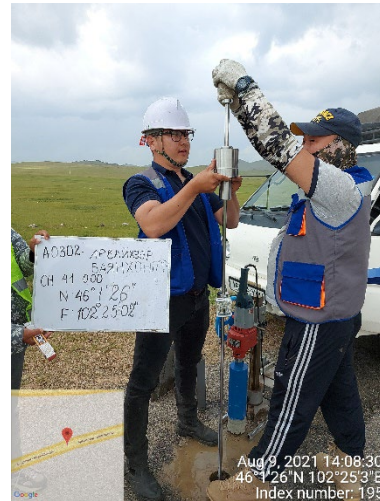
Арвайхээр – Баянхонгор чиглэлийн авто замд DCP багажаар хэмжиж байгаа нь
