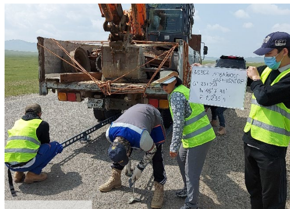
Арвайхээр – Баянхонгор чиглэлийн авто замд хэмжилтийн автомашины ачааллыг хэмжиж байгаа нь
