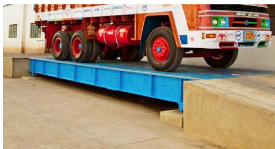
Суурин буюу гүүрэн автопүү 13-р зураг. Статик аргын багаж төхөөрөмж
