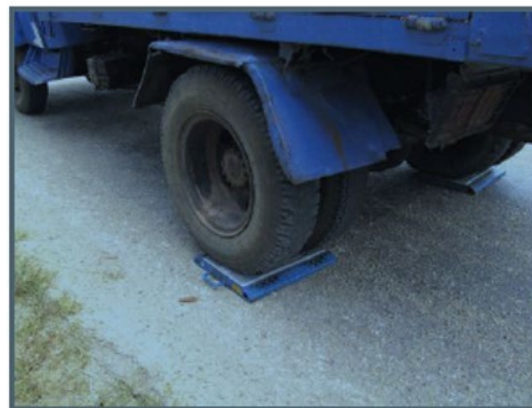
Зөөврийн пүү ашиглан хойд тэнхлэгийн хэмжилт хийж байгаа нь
