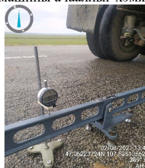
Авто замд бенкелманы багажаар хотойлт хэмжиж байгаа нь
