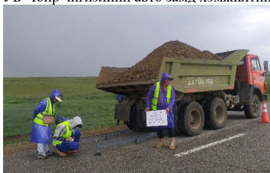
Авто замд бенкелманы багажаар хотойлт хэмжиж байгаа нь
