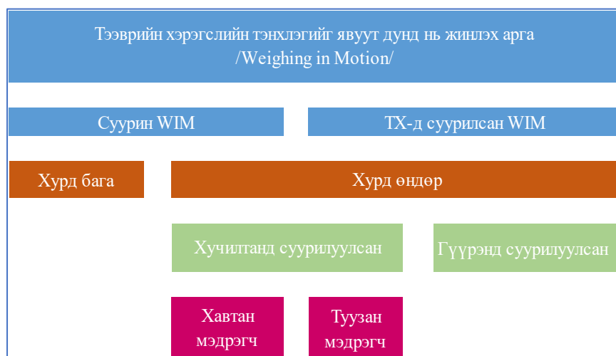
15-р зураг. Тээврийн хэрэгслийн тэнхлэгийн ачааллыг явуут дунд нь жинлэх аргын төрөл
