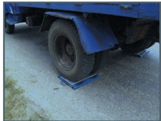
Зөөврийн пүү ашиглан хойд тэнхлэгийн хэмжилт хийж байгаа нь
