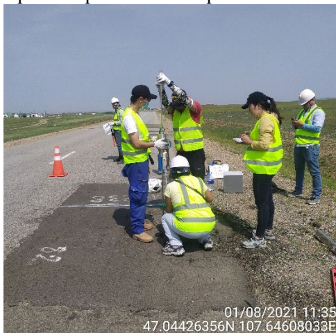
УБ-Чойр чиглэлийн авто замд DCP багажаар хэмжиж байгаа нь
