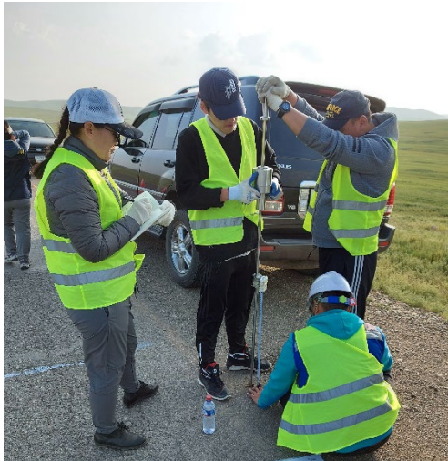
Арвайхээр – Баянхонгор чиглэлийн авто замд DCP багажаар хэмжиж байгаа нь
