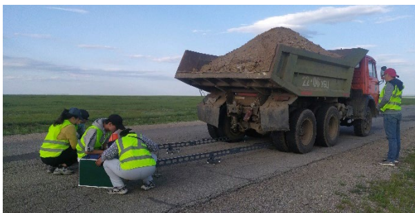
Авто замд бенкелманы багажаар хотойлт хэмжиж байгаа нь
