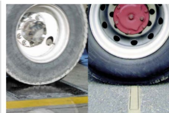
6-р зураг: Хавтан ба судал мэдрэгч дээгүүр дугуй өнгөрөх байдал
