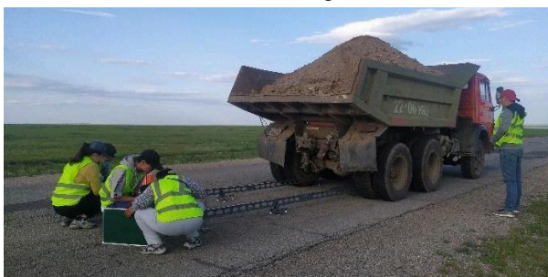
Авто замд бенкелманы багажаар хotoйлт хэмжиж байгаа нь
