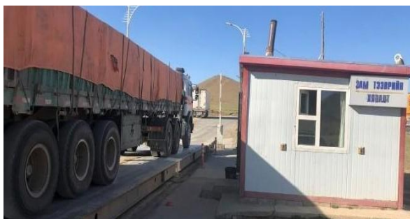
9-р зураг. Суурин (Гүүрэн) авто пүүгээр тээврийн хэрэгслийн нийт жинг хэмжиж байгаа нь
