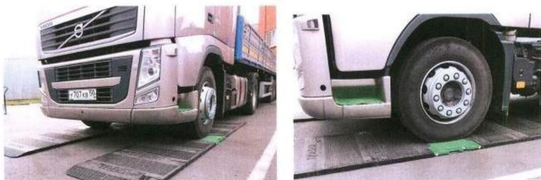
Зураг 7. Хэмжилтийн үед тээврийн хэрэгслийн дугуйг байрлуулах байдал
