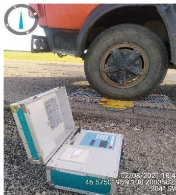
УБ-Чойр чиглэлийн авто замд хэмжилтийн автомашины ачааллыг хэмжиж байгаа нь
