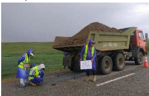
Авто замд бенкелманы багажаар хotoйлт хэмжиж байгаа нь
