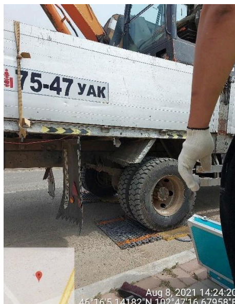
Арвайхээр – Баянхонгор чиглэлийн авто замд хэмжилтийн автомашины ачааллыг хэмжиж байгаа нь
