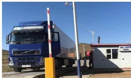
9-р зураг. Суурин (Гүүрэн) авто пүүгээр тээврийн хэрэгслийн нийт жинг хэмжиж байгаа нь
