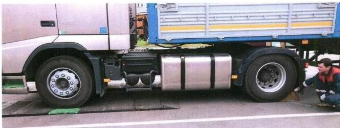
Зураг 8. Тээврийн хэрэгслийн зөөврийн автопүү дээр байрлуулсны дараа дугуйнд эвээс хийж аюулгүй байдлыг хангах.
