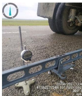
УБ-Чойр чиглэлийн авто замд хэмжилтийн автомашины ачааллыг хэмжиж байгаа нь
