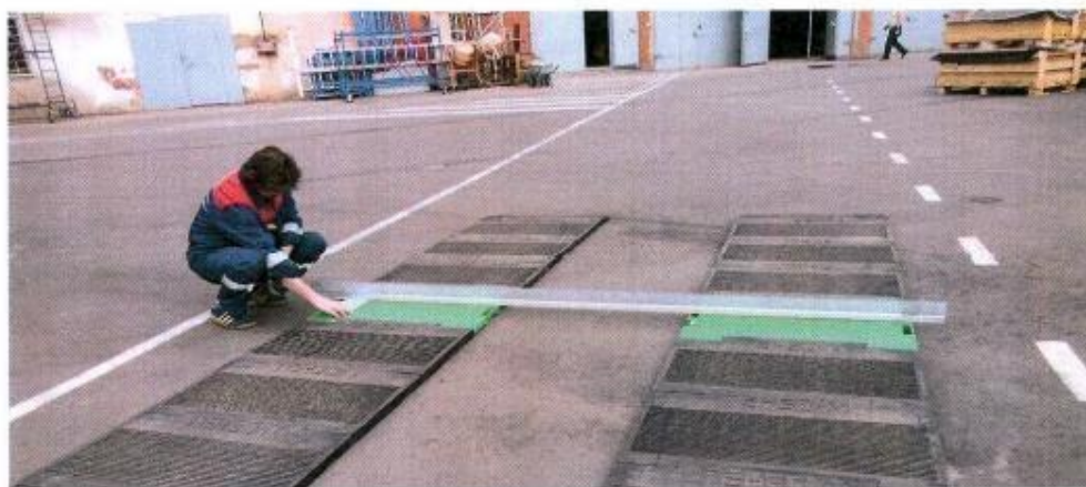
Зураг 4. Автопүүгийн хоёр жингийн хоорондох түвшинг шалгаж, тохируулах.
