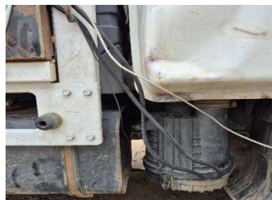
Зураг 3.4-5. Хөдөлгүүрийн оруулах хоолой дээрх агаарын урсгал хэмжигчийг суурилуулалт
