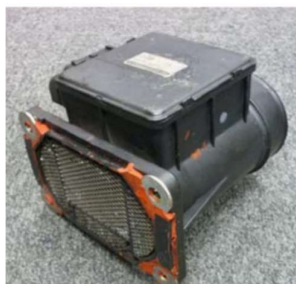
Зураг 3.4-5. Хөдөлгүүрийн оруулах хоолой дээрх агаарын урсгал хэмжигчийг суурилуулалт
