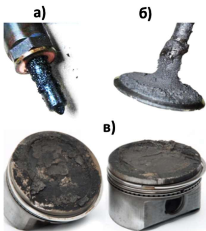
Зураг 2.5-4. Хөдөлгүүрийн эд ангид үүсэх хаг, хөө, тортог а) инжектор, б) хавхлага, в) поршен
