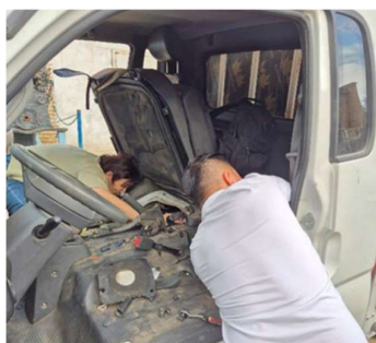
Зураг 3.4-6. Тахир голын эргэлт, хурдны мэдрэгчүүдийн холболтыг хийх
