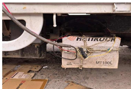
Зураг 3.4-7. NO x болон PM хэмжих HORIBA PEMS цогц төхөөрөмжийг аккумулятортай холбох
