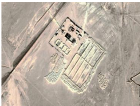
Зураг 3-13: Сайншанд сумын 2-р багт байрлах 3000 м 3 /хоног хүчин чадал бүхий цэвэрлэх байгууламж ( Одоохондоо ашиглаагүй байгаа)
