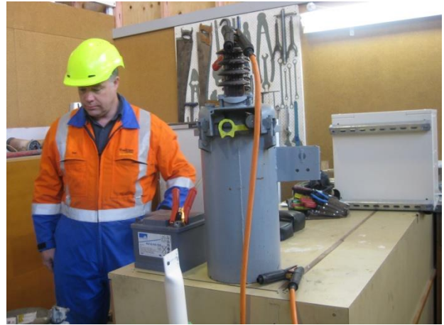
Реклюзорыг лабораторийн нөхцөлд хэрхэн шалгах тухай Зураг 10
