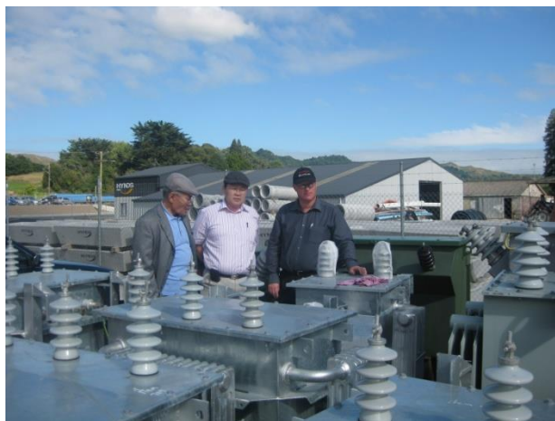
"SWER"-ийн төрөл бүрийн хүчин чадалтай трансформаторын үйлдвэрлэл. Зураг 7.
