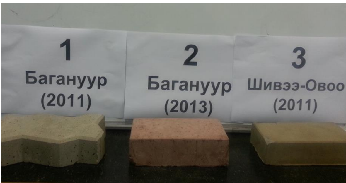
24-р зураг. Цацрагийн үзүүлэлтийг хэмжсэн геополимер бетон
