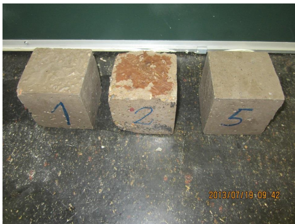
23-р зураг. Хүйтэн тэсвэрлэлтийн 40 циклийн дараахь геополлимер бетон
