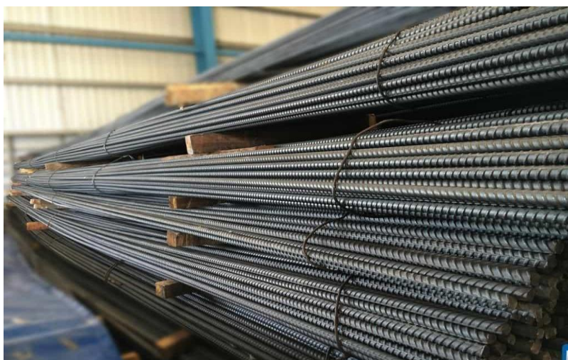
Зураг 2. 4. Барилгын иржгэр арматур
