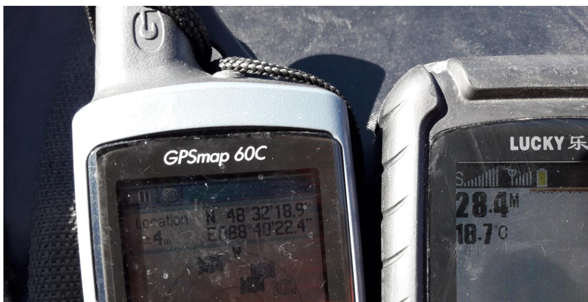
3.7 дугаар зураг. Нуурын усны гүн, гадаргын температур ба түүний байрлалыг хэмжсэн байдал
