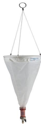
4.2 дугаар зураг. Усны хөвөгч амьтан цуглуулагч планктоны тор
