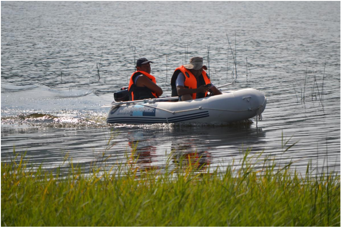
3.3 дугаар зураг. Hydroforce маркийн резинен завь ба 2 морины хүчин чадалтай мотортой завиар Хар Зүрхний Хөх нуурт усны гүний хэмжилт хийж байгаа нь
