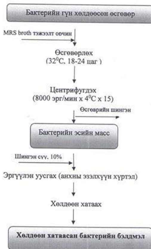
ГУРАВ. Сүүнхүчлийн бактерийн хөлдөөн хатаасан бэлдмэл бэлтгэх технологи схем
