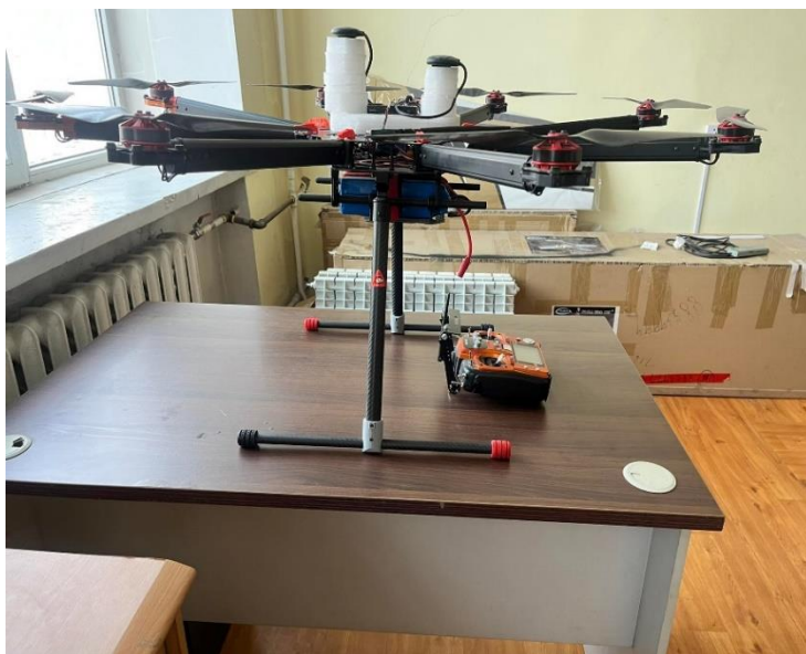
Зураг 31. “Tarot T1000” дроны их бие ба PIXHAWK V4 удирдлагын системийг суурилуулсан байдал.
