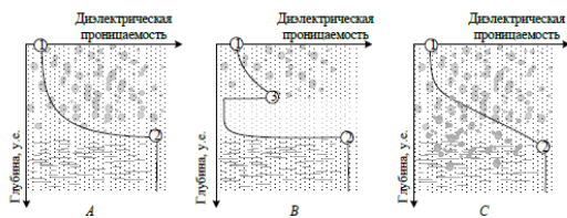
Рис. 3. Возможные типичные равновесные модели изменения диэлектрической проницаемости грунта: А – модель грунта с неполным водотоком канала, В – модель грунта с полным водотоком канала, С – модель с грунтовой водой.
