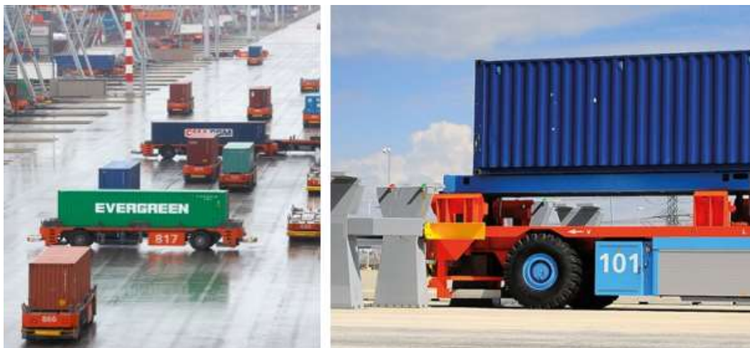
Зураг 27. Логистикийн төв, ачааны терминалд ажиллаж буй автомат удирдлагатай тээврийн хэрэгсэл
