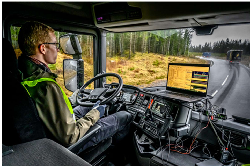
Зураг 10. Ачааны автомашиныг автомат удирдлагын/жолоодлогын систем болон интернет орчинд холбогдох холболтын технологийг ашиглан гүйцэтгэж буй ачааны автомашины технологийн туршилт
