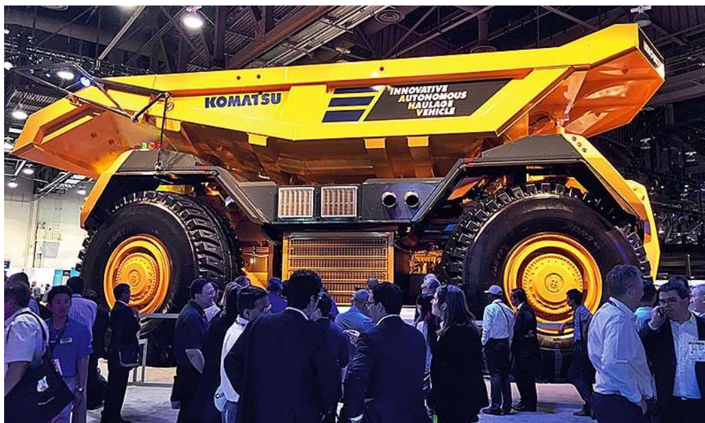
Зураг 32. Уул уурхайд ашиглагдах хүнд даацын автомат удирдлагатай тээврийн хэрэгсэл
