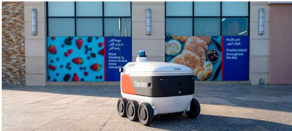
Зураг 35. Хүргэлтийн үйлчилгээнд ашиглагдаж буй автомат удирдлагатай тээврийн хэрэгсэл/роботууд
