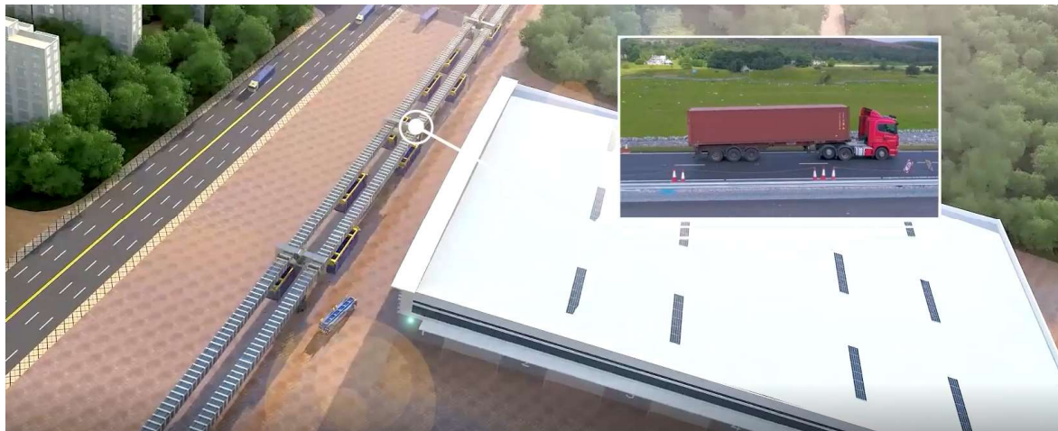
Зураг 15. Автотээврээр ирсэн ачааг тулгуурт гүүрэн байгууламж бүхий ачаа тээврийн ухаалаг системд шилжүүлэн ачих боломж
