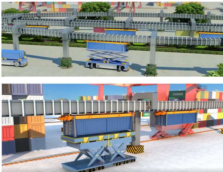
Зураг 19. Автомат удирдлага бүхий автомашин (AGV)
