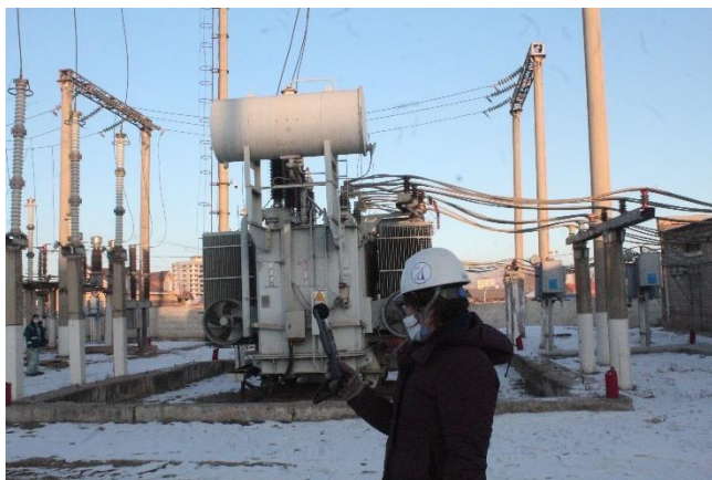
Зураг 14. СЕМ DT-8820 орчны хэмжилтийн багажаар хэмжиж буй байдал /Харьцангуй чийг, дуу чимээ/
