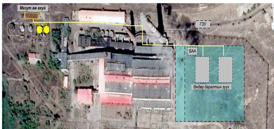
Зураг-3.16. Мазут аж ахуйн байршил ба өргөтгөлийн зуухыг шингэн түлшинд холбох шугамын тойм зураг
