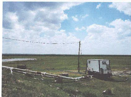
8-р зураг. Гидрогеологийн цооногт шавхалт туршилтын ажил гүйцэтгэж буй ажлын зураг /Эрдэнэдрейлинг ХХК-ны бүрэн автомат лаборатори/
