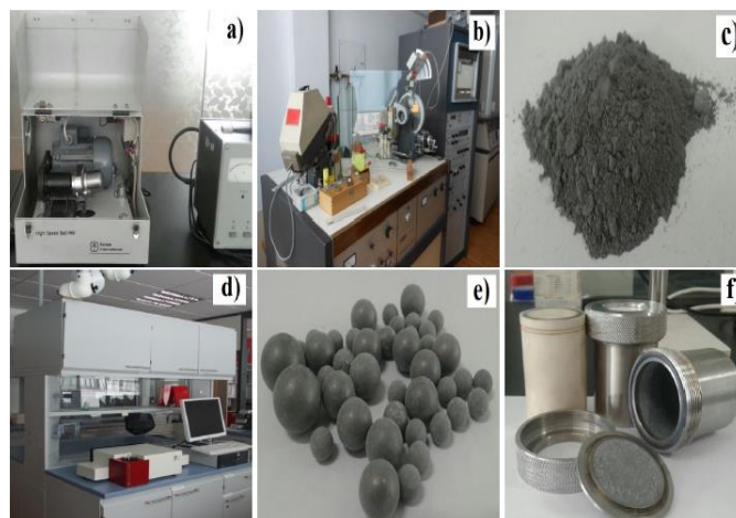
2.14-р зураг. Нунтаглах процесс явуулахад ашигласан багажууд: а) Өндөр энергийн чичиргээт бөмбөгөн тээрэм, б) рентген дифрактометр, с) нунтаг TiO_2 дээж, д) Фотоны хөндлөн корреляцийн спектроскоп (PCCS with Nanophox), е) янз бүрийн диаметртэй зэвэрдэггүй ган бөмбөгүүд, ф) нунтаг дээж хийх зориулалттай ган сав
