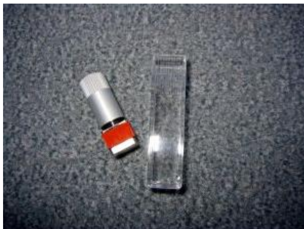
2.11-р зураг. Nanorhox-ийн стандарт савны эрэгтэй таг, гадаад талбай нь 10 \times 10 \text{ мм}^2 , жийргэвч материал нь силикон, 5 ширхэгтэй.
