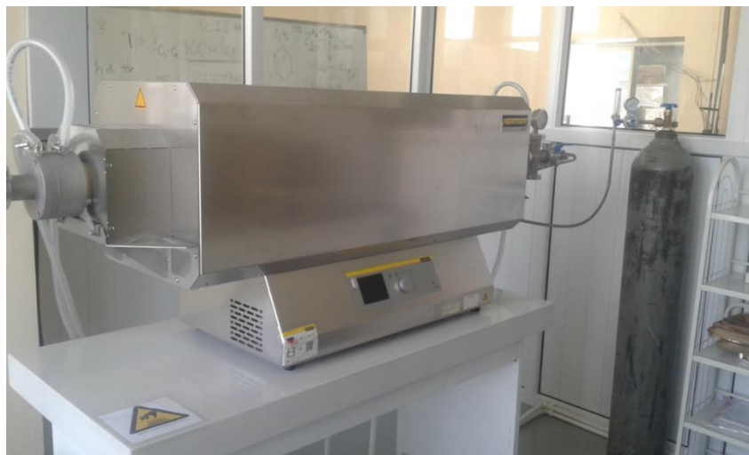
3.1-р зураг. Өндөр температурын <Nabertherm> шатаах зуух
