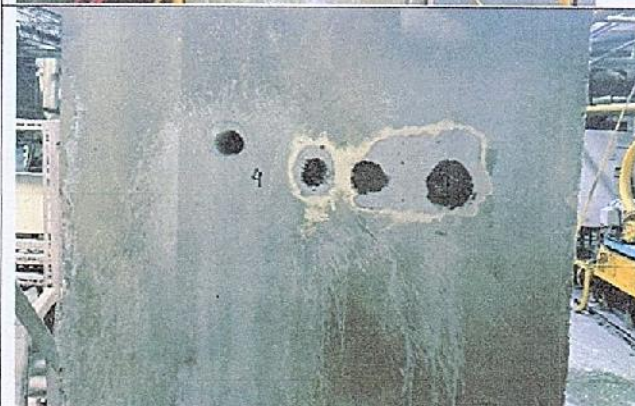
12,13,14,15-р зураг. Төмөрбетон бүтээцээс сорьц авсан байдал.
