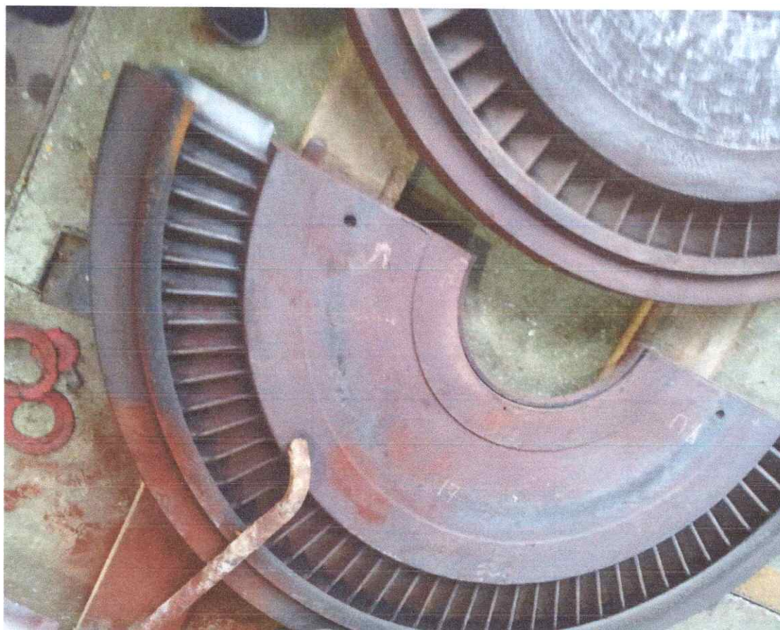
1-р зураг. “ТГ-8” турбины диск, чиглүүлэх хүрэмүүдийн зэвэнд идэгдсэн байдал
