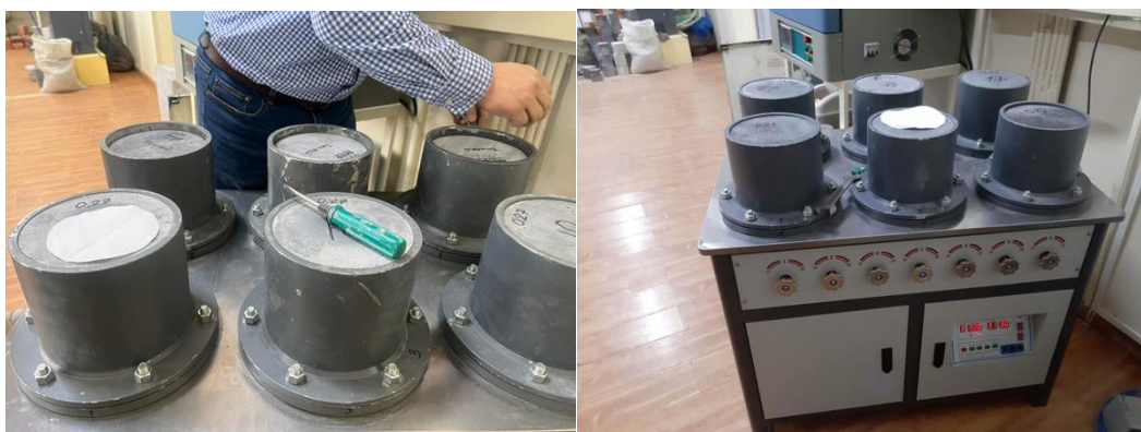
3.26-р зураг Ус нэвтрүүлэлтийг туршиж буй байдал
