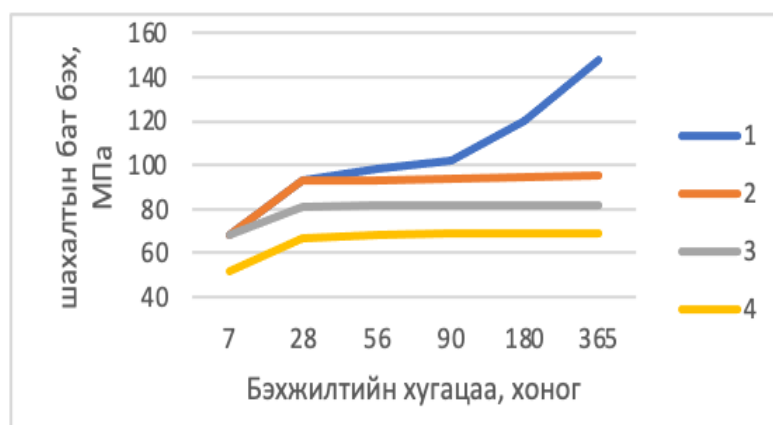
3.32-р зураг. Хүрээлэн байгаа орчны чийглэг нөхцөлөөс бат бэхийн өсөлт хамаарах байдал. (Цахиурын тоосонцор нэмсэн цементээр 2018-2020 онд хийсэн туршилт). 1 - жилийн турш стандартын нөхцөлд бэхэжсэн, 2 -28 хоног стандартын нөхцөлд цаашид агаарт, 3 -7 хоног стандартын нөхцөлд цаашид агаарт, 4 –Тасалгааны хуурай нөхцөлд 365 хоног хадгалсан.
