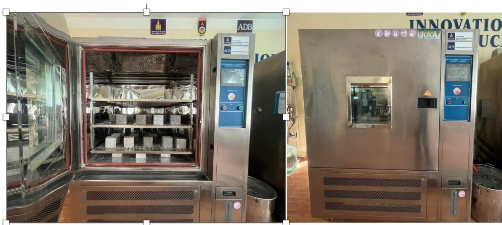
3.25-р зураг Хүйтэн тэсвэрлэлтийг туршиж буй байдал
