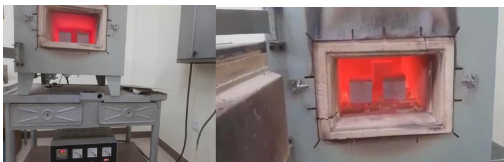
3.27-р зураг Сорьцын температурын үйлчлэлийг туршиж буй байдал
