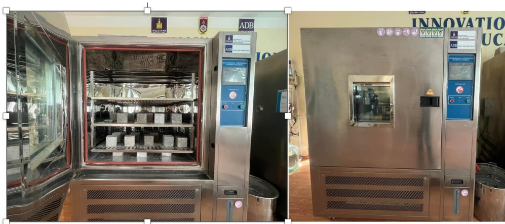
3.25-р зураг Хүйтэн тэсвэрлэлтийг туршиж буй байдал
