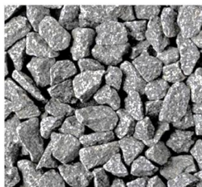
3.7-р зураг. Бутлан ангилах үйлдвэрээс гарсан дайрганы төлөв байдал
