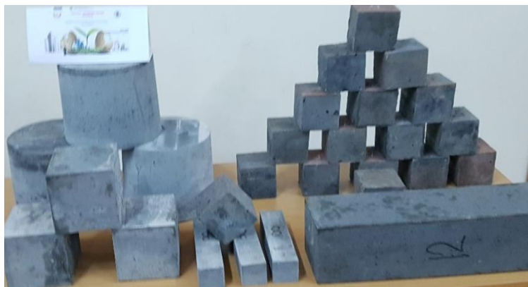
3.3-р зураг. Баянголын дайрган дүүргэгчтэй өндөр марктай сорьцын бэхэжсэний дараах төлөв байдал
