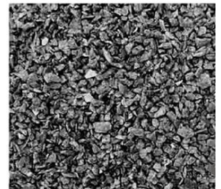
3.7-р зураг. Бутлан ангилах үйлдвэрээс гарсан дайрганы төлөв байдал
