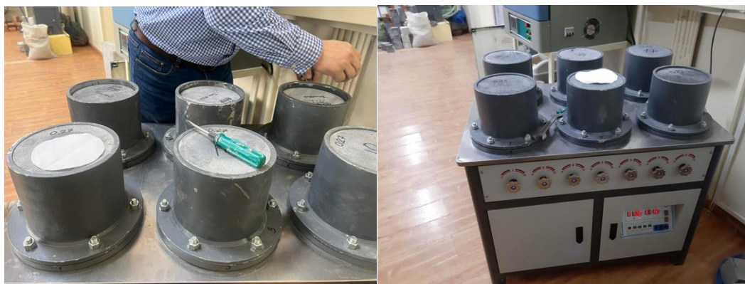
3.26-р зураг Ус нэвтрүүлэлтийг туршиж буй байдал
