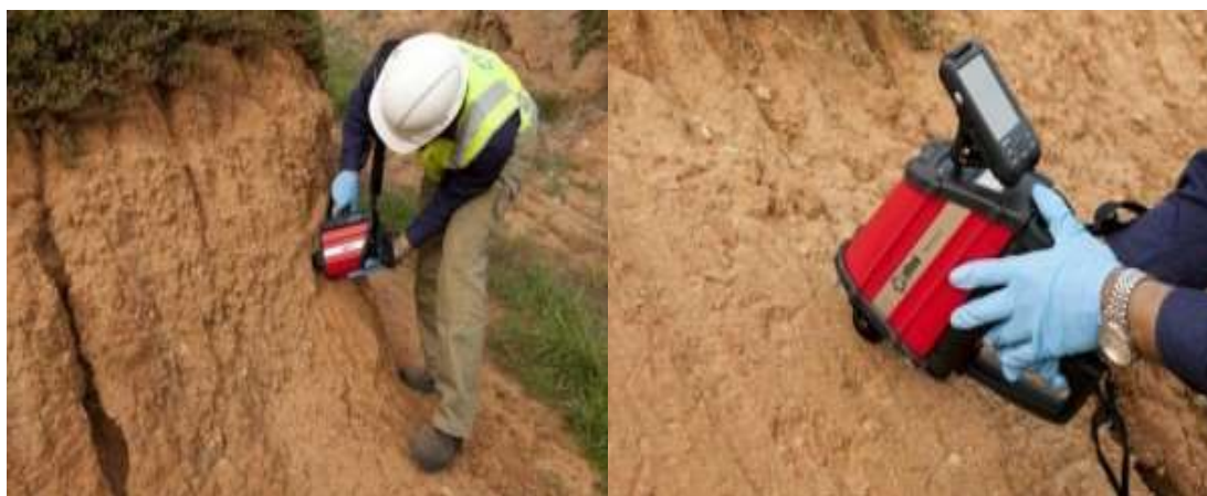
Зураг 6.16. Хөрсөн дэх газрын тосны бүтээгдэхүүний бохирдолтыг тодорхойлох шинэ портатив төхөөрөмж
