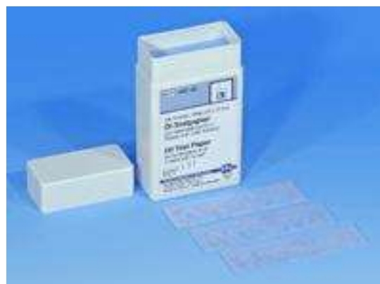
Зураг 6.15. Хөрс, усан дахь газрын тосны бүтээгдэхүүнийг тодорхойлох түргэвчилсэн судалт-тестийн арга буюу цаасан индикатор.патент-Кат.№ 907 60
