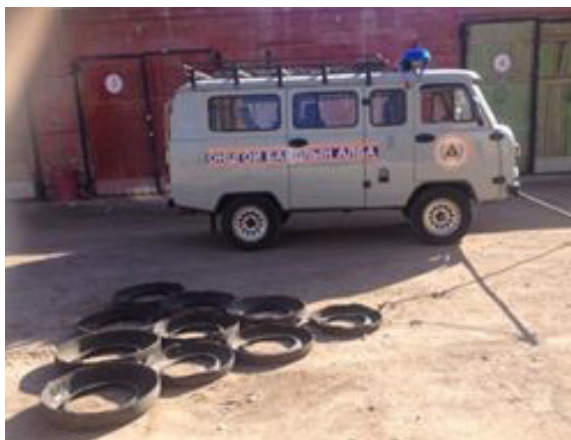
Зураг 33. Түймрийн хавирганы галыг унтраах зориулалт бүхий чирэгч дугуй
