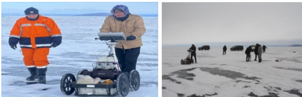
Зураг 74. Шведийн MALA брэндийн Георадарын судалгааны багажаар Хөвсгөл нуурт живсэн тээврийн хэрэгслийг эрэн хайх, илрүүлэх туршилтын ажиллагаа
