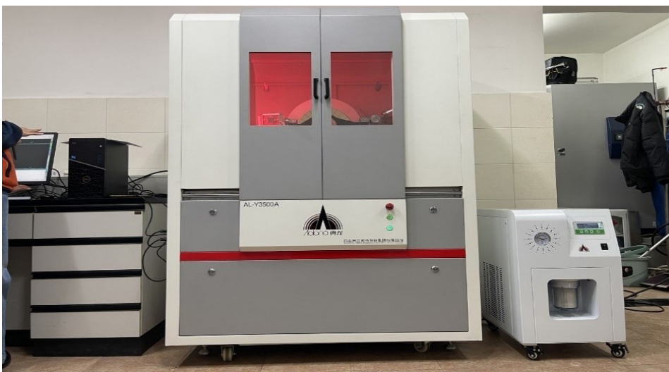
Зураг 52. Рентген туяаны дифрактометр – TC XRD төхөөрөмж
