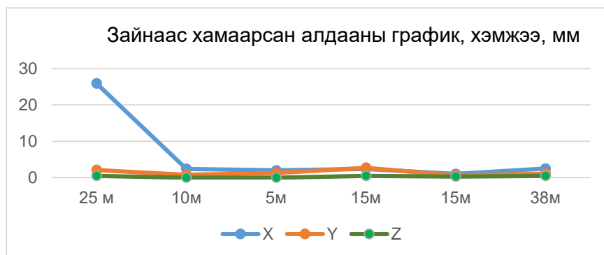
1 дүгээр зураг. GNSS багажаар хийсэн хэмжилтийн дундаж квадрат алдаа зайнаас хамаарсан график
