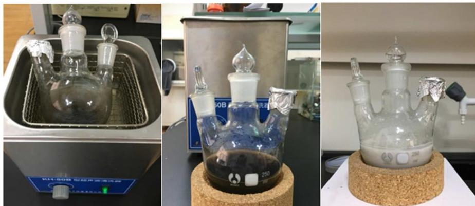
*Зураг 1.2. Графен оксид болон  $\text{Li}_4\text{Ti}_5\text{O}_{12}$ -ын холимог уусмал*
