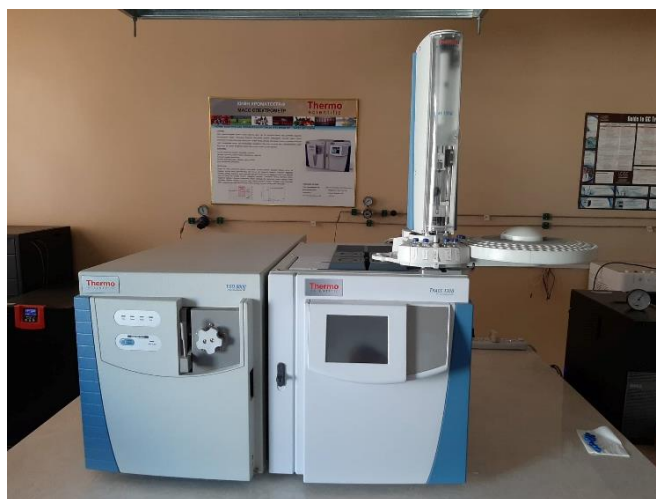
18-р зураг. Хийн хроматограф GC/MS Thermo Scientific–Trace 1310 GC.
