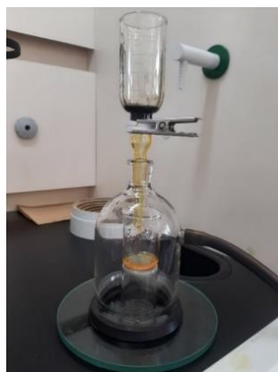
16-р зураг. Бүтээгдэхүүнийг катализатороос вакуум шүүлтүүр ашиглан салгаж байна.
