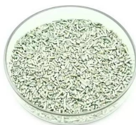
2-р зураг. Хөнгөнцагааны оксидод суурилсан никель молибдений катализатор.
