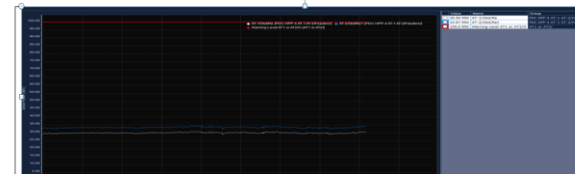
АШ-205,206 засвар хийхтэй холбоотой ИХБ-4-ийн АТ-1,2-ийн ачааллыг хянах функц үүсгэн чадлын урсгалыг 100МВт байхаар тооцож дохиолол оруулсан
