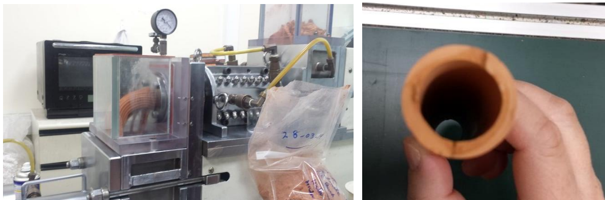
46-р зураг. KTE-50S маркийн экструдерээр хэвлэсэн мембран
