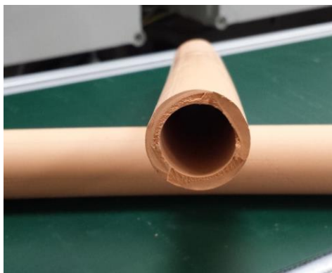
50-р зураг. 800^{\circ}\text{C} -ийн температурт шатааж гарган авсан керамик мембран
