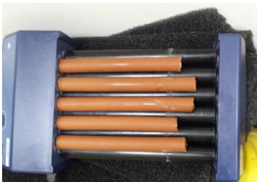
47-р зураг. Хэвлэсэн мембраныг тасалгааны температурт хөдөлгөөнт байдлаар жигд хатааж буй байдал
