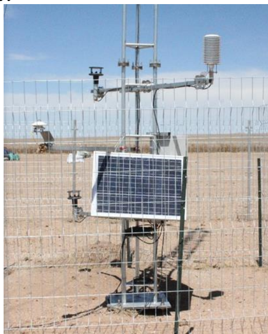
55 дугаар зураг. Чойрын судалгааны сууринд шороон шуурга, цаг уурын үзүүлэлтүүдийг хэмжих автомат цаг уурын станц
