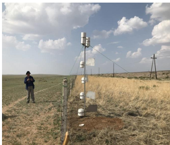
54 дүгээр зураг. Төмөр зам, засмал замын дагуу байрлуулсан элс баригч багаж
