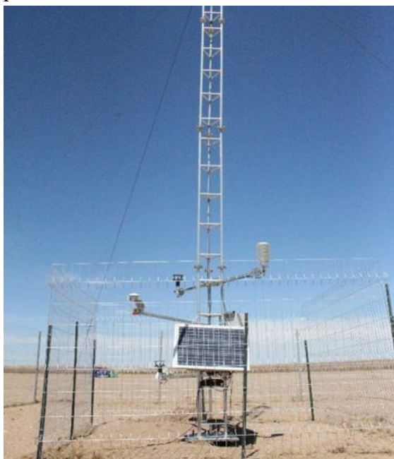
55 дугаар зураг. Чойрын судалгааны сууринд шороон шуурга, цаг уурын үзүүлэлтүүдийг хэмжих автомат цаг уурын станц
