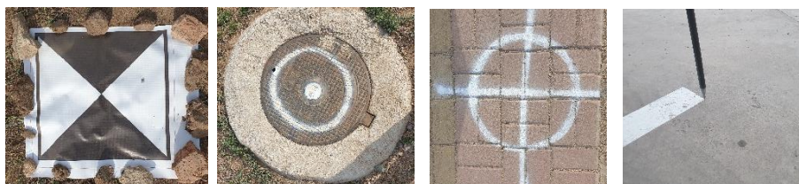
Зураг 3. Газрын холболтын цэгүүдийн тэмдэглээсийн хэлбэр
