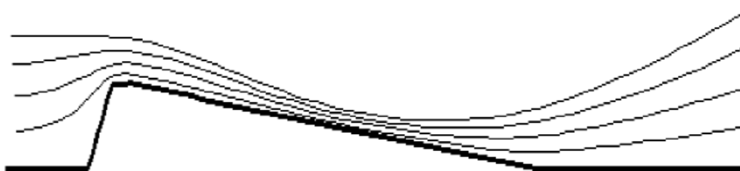
Рисунок.4. Поток над пологой плотиной C=0.96\sqrt{gh} .
