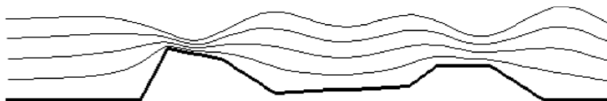
Рисунок.6. Поток над двугорбой мелью C=0.55\sqrt{gh} .
