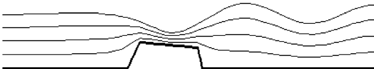
Рисунок.5. Поток над четырехугольным дном C=0.696\sqrt{gh} .
