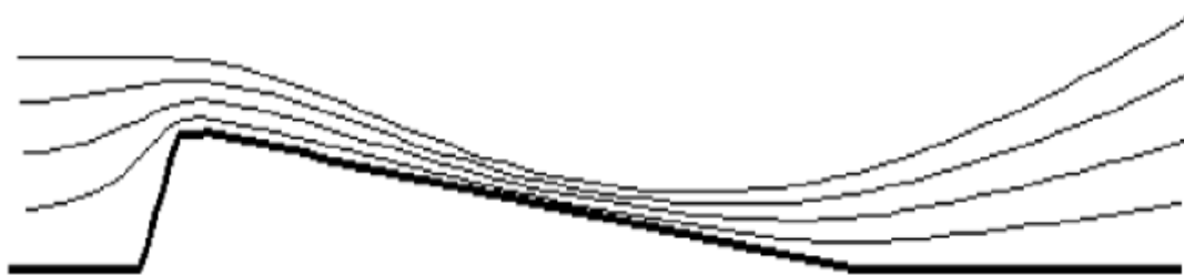
Рисунок.4. Поток над пологой плотиной C=0.96\sqrt{gh} .
