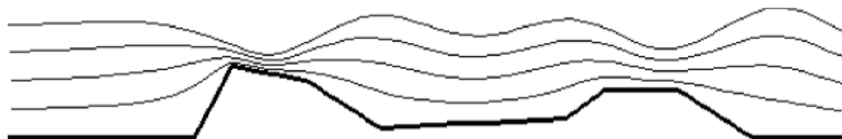
Рисунок.6. Поток над двугорбой мелью C=0.55\sqrt{gh} .
