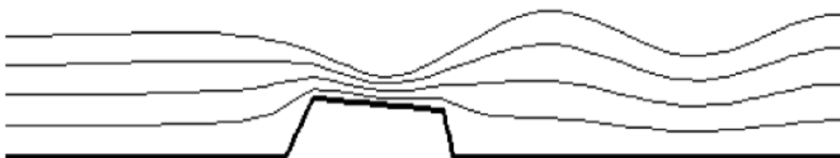
Рисунок.5. Поток над четырехугольным дном C=0.696\sqrt{gh} .
