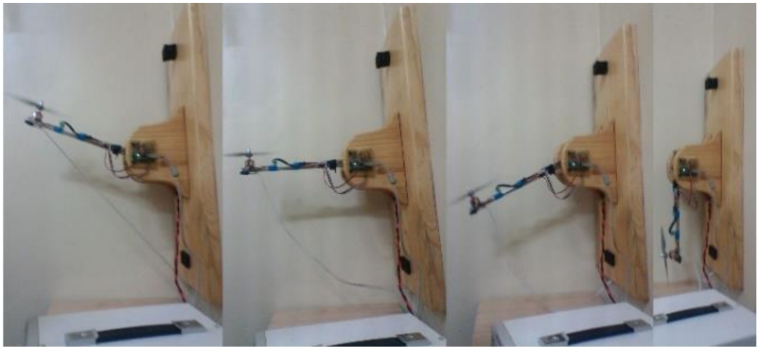
Зураг 2.1.2 Нэг сэнст дүүжин. Баруун талаас дүүжингийн анхны байрлал, дүүжин 45^{\circ} байрлалд, 90^{\circ} байрлалд, 110^{\circ} байрлалд
