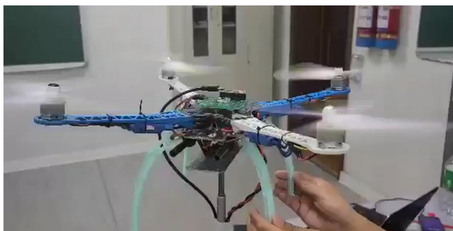
Зураг 4.5.6 Дөрвөн сэнст төхөөрөмж нейрон сүлжээтэй удирдлага
