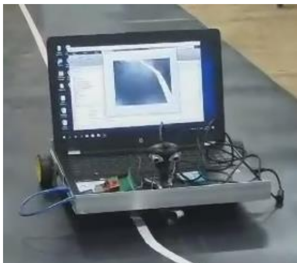
Зураг 4.5.10 Төслөөс үүссэн бусад төхөөрөмж “Хиймэл оюун ухаанд суурилсан цагаан зураас дагадаг робот”
