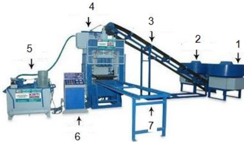
Зураг 137. Бага маркийн бетон эдлэл үйлдвэрлэх технологи дамжлага
