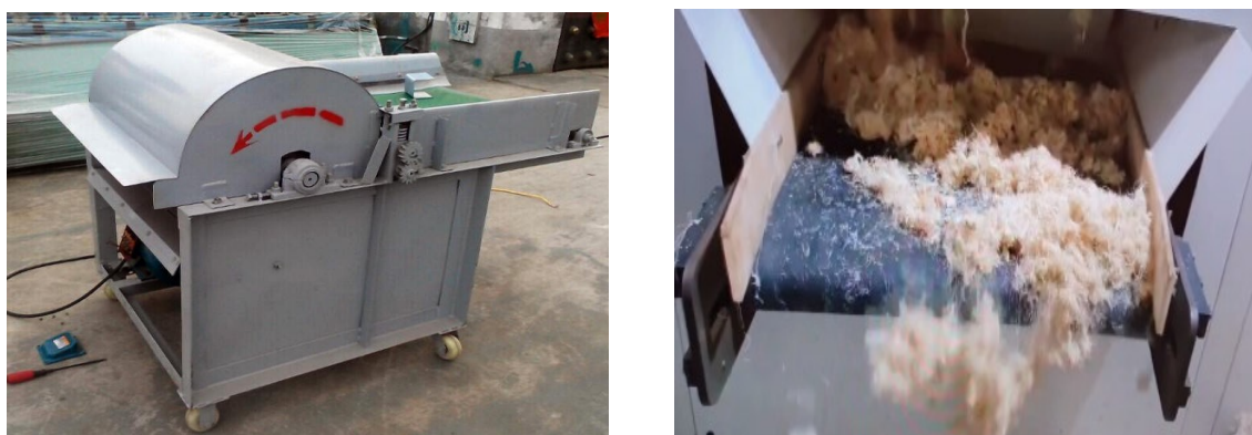
Зураг 10. Сэмлэх машин, сэмлэгдсэн ноосны гаралтын хэсэг
