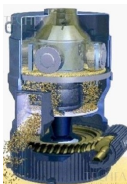
Зураг 7. 1-ZLSP150B маркийн машины шахмалын механизмын байдал, 2-ZLSP150B маркийн үрлэн шахмалын машины гадаад байдал
