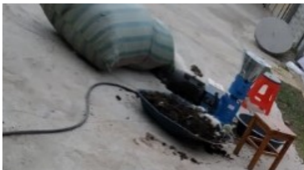
Зураг 4. Бордооны тээрмийн машиныг ажиллагааг туршсан байдал
