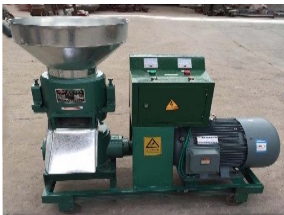
Зураг 7. 1-ZLSP150B маркийн машины шахмалын механизмын байдал, 2-ZLSP150B маркийн үрлэн шахмалын машины гадаад байдал
