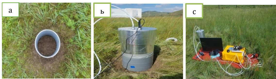
Зураг 4.17. Хөрсний гадаргаас ялгарч байгаа CO 2 хэмжилт а)-20 см диаметртэй PVC хоолой б)-битүүмжилсэн chamber с)- Los Gatos Research (LGR) буюу Ultra-portable Gas Analyzer
