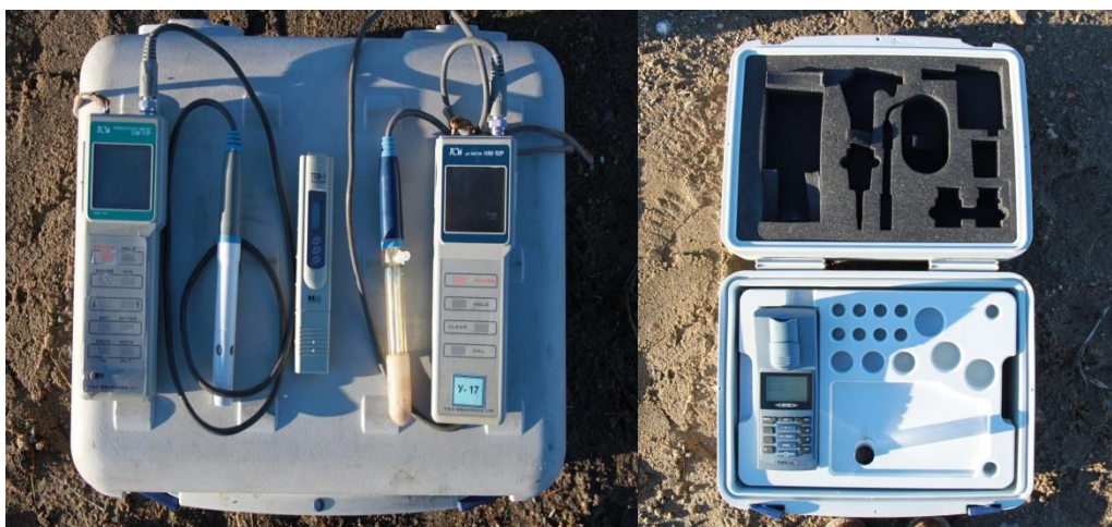
Зураг 2. Хээрийн хэмжилтийн багажууд (TOA CM-11P, TDS meter, TOA HM-10P, Turb 430 IR/Set)
