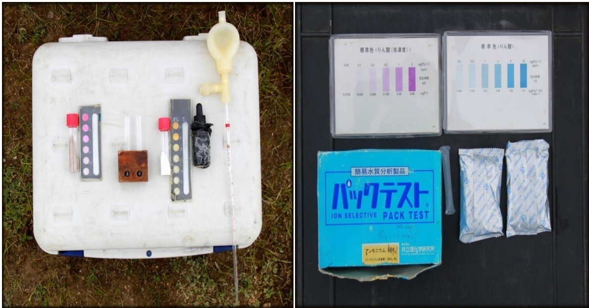
Зураг 6. Газар дээр нь харьцуулах аргаар аммони, нитрат, ортофосфат хэмжих үед ашигласан зүйлс
